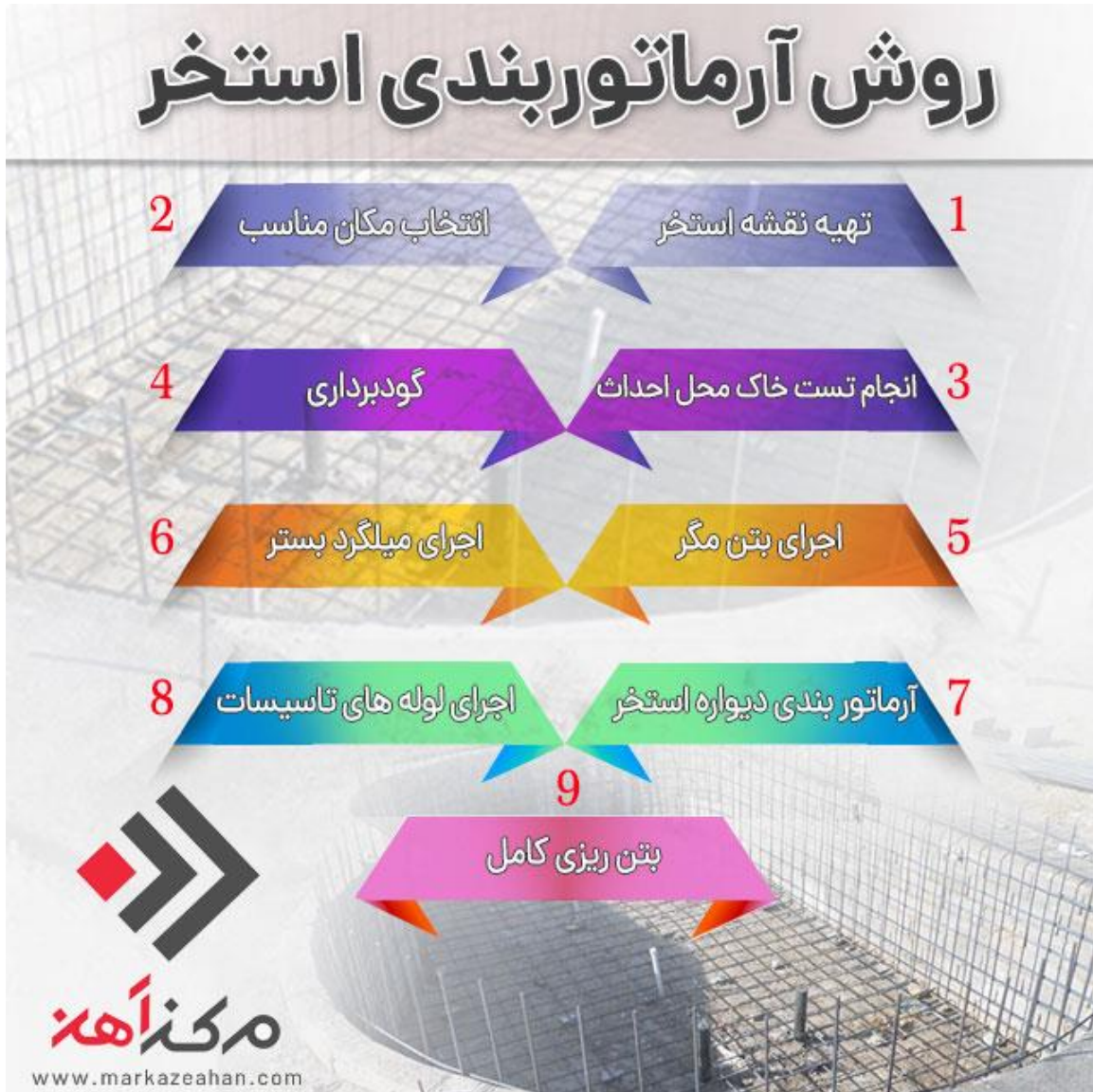
آرماتوربندی دیواره استخر
